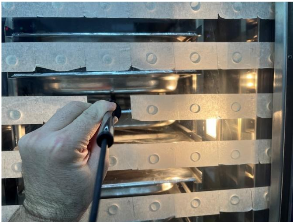
Görsel 4. Ölçüm Merkezleme Aparatı Kullanılarak Termal Anemometre ile Alınan Ölçümler
