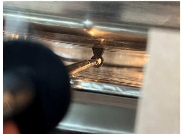
Görsel 4. Ölçüm Merkezleme Aparatı Kullanılarak Termal Anemometre ile Alınan Ölçümler
