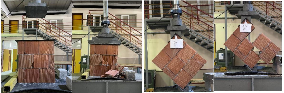
Görsel 6 (a)b-0-c, (b)b-0-s, (c) b-1-c, (d) b-1-s deney numunelerinin test edilmesi
