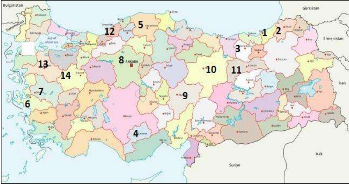
Görsel 2. Türkiye'de kullanılan maden dolgu yöntemleri (1:Rize Çayeli Bakır İşletmeleri,Macun dolgu, 2:Artvin Murgul Bakır İşletmesi,Kaya (pasa)dolgu, 3:Gümüşhane Gümüştaş Bakır İşletmeleri, Kaya (pasa)dolgu, 4:Karaman Ermenek, Kaya (pasa)dolgu, 5:Kastamonu Küre, Kaya (pasa)dolgu, 6:İzmir Efem Çukuru Tüpraş, Kaya (pasa)dolgu, 7:Manisa Soma, Kaya (pasa)dolgu,Uçucu kül malzemesi, 8:Ankara Çayırhan Park Termik Santrali, Beton Püskürtme,uçucu kül,pasa dolgu, 9:Kayseri Yahyalı, Kaya (pasa)dolgu, 10:Sivas Divriği Demir İşletmesi , Kaya (pasa)dolgu, 11:Erzincan Tercan, Kaya (pasa)dolgu, 12:Zonguldak TTK, Kaya (pasa)dolgu, 13:Balıkesir Balya Kurşun-Çinko,Macun dolgu, 14:Kütahya Tavşanlı, Kaya (pasa)dolgu)
