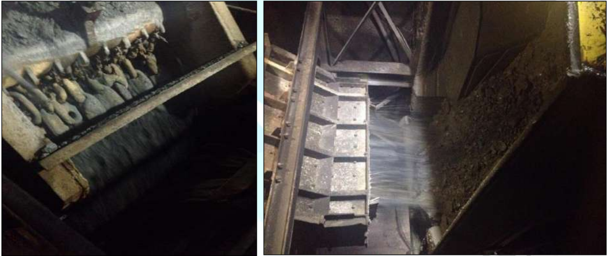
Görsel 1. Çimentolu pasa dolgunun pasanın bulunduğu kuyu ağazı ve enjeksiyon karışması
