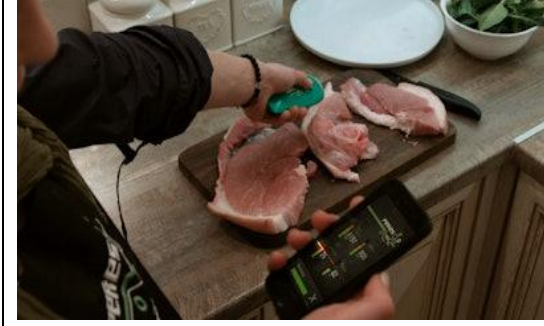
Görsel 7. Et bozulma oranını tespit eden taşınabilir e-nose cihazı (electronic nose analyzes, 2014)
