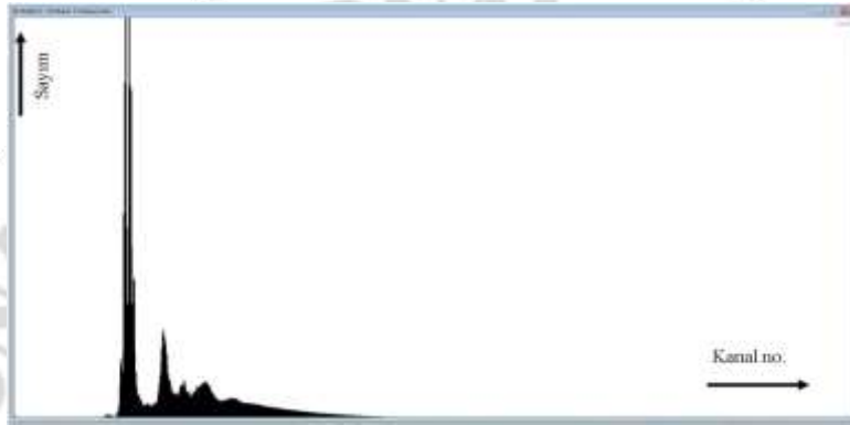
Görsel 3. Alfa kaynağı yok iken elde edilen enerji spektrumunun şekli (tabii fon).
