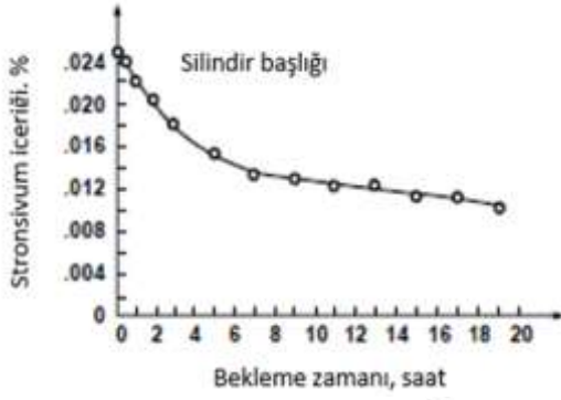
Görsel 3. A319.2 (AA303) döküm alaşımı silindir başlığında Sr ilavesinin zamanla sönümü [11]
