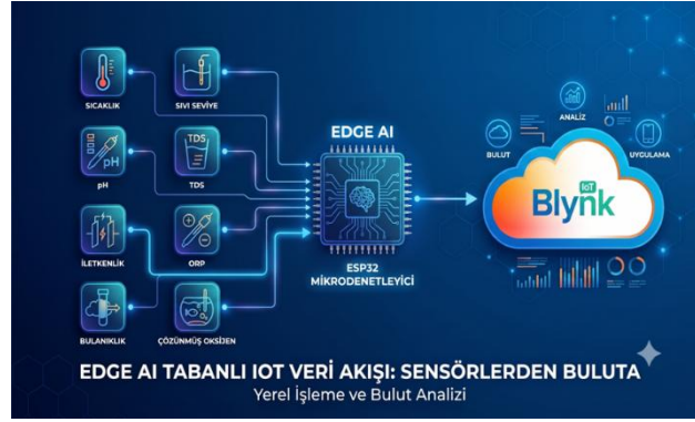
Görsel 1. Geliştirilen IoT tabanlı çok sensörlü su kalitesi izleme sisteminin genel mimarisi.
